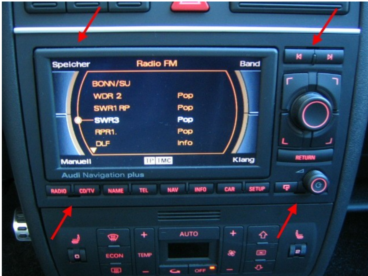
Bild 9: Position der Endriegelungsstellen am RNS-E
