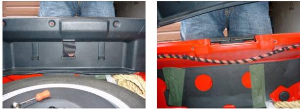
Zurück bleiben nur noch die Seitenverkleidungen. Hier jetzt die gelb markierte Kunststoffschraube entfernen und schon kann man die Seitenverkleidung ein wenig anklappen. Jetzt wird die Verkleidung nur noch von der Kofferraumdichtung gehalten, diese ein wenig anheben und die Verkleidung vorziehen.
