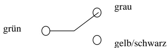
Die Relaiskontakte und Leitungsfarben der Funkfernbedienung für *schließen*:
