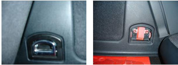
Als nächstes die Heckverkleidung, an der auch das Warndreieck befestigt ist entfernen, dazu die 4 Torx Schrauben lösen. Die Verkleidung nach oben biegen und unter dem Dichtungsgummi heraus nehmen.
