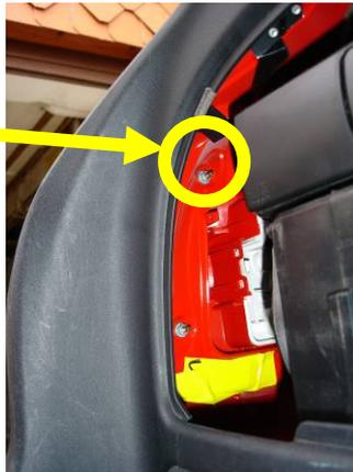
Die Zentralverriegelungspumpe habe ich im Bild gelb markiert, hier müssen die Leitungen für die Spannungsversorgung und die Türfunktion abgegriffen werden. Die Pumpe anschließend wieder gut befestigen um Störungen zu vermeiden.
