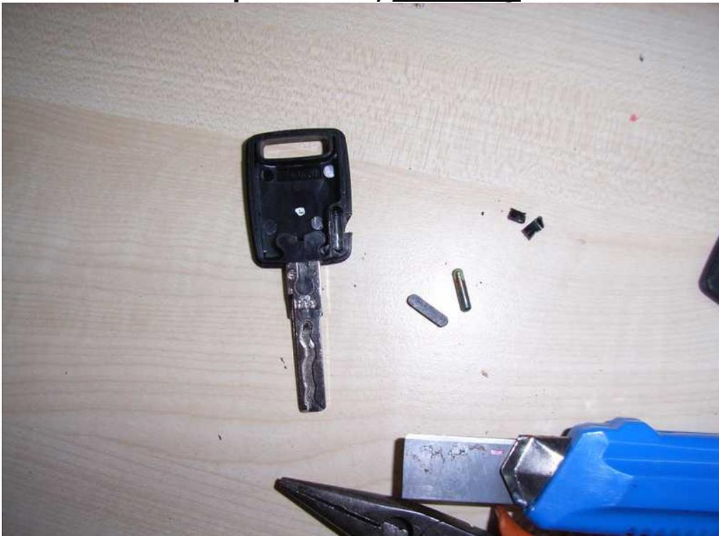
**7. Jetzt muss der neue Klappschlüssel zerlegt werden. Das ist recht einfach, da alles nur geschraubt ist. Ihr löst einfach die beiden Schrauben am Kopf des Schlüssel, sowie die beiden Schrauben unter dem Sticker (Logo).**
