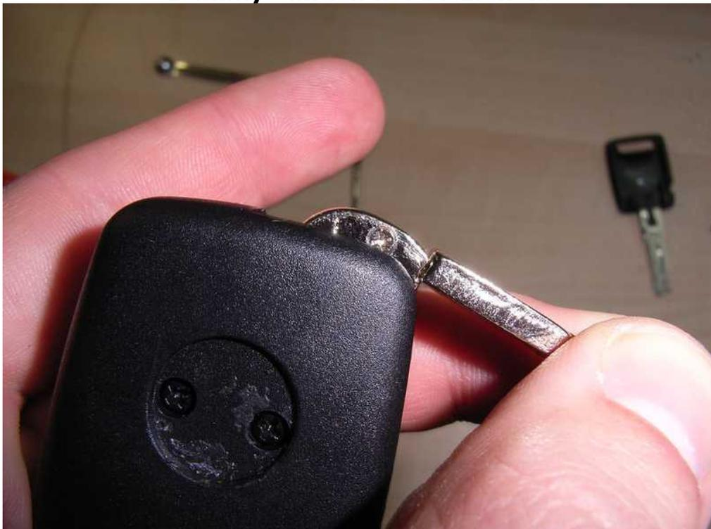
**Beim Montieren des nachgemachten Schlüssels müsst Ihr wie in dem Foto zu sehen, mit etwas Kraft den Schlüssel gerade halten und die Schrauben festziehen. Sonst kann es sein, dass der Schlüssel etwas wackelt, lässt sich nachher aber auch noch nachjustieren.**
