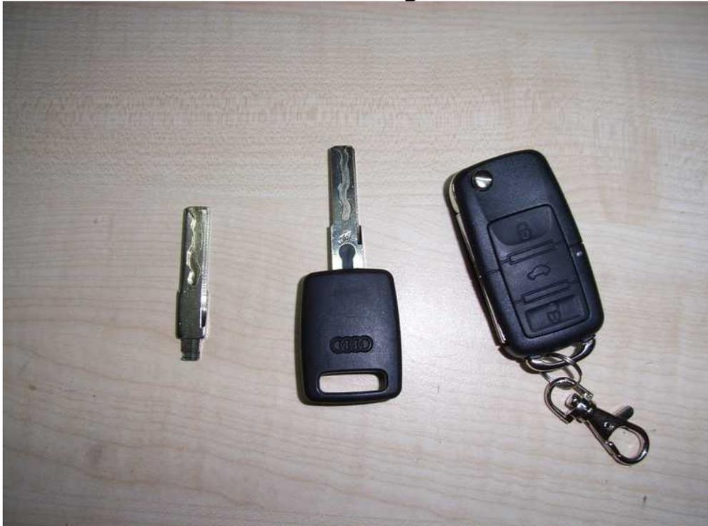
**3. Um den alten original Schlüssel zu öffnen, verwendet Ihr am Besten ein Taschen- oder Cuttermesser. Das Plastikteil sind einfach nur 2 zusammengeklippte Hälften, die man mit einem Messer schnell aufhebeln kann.**
