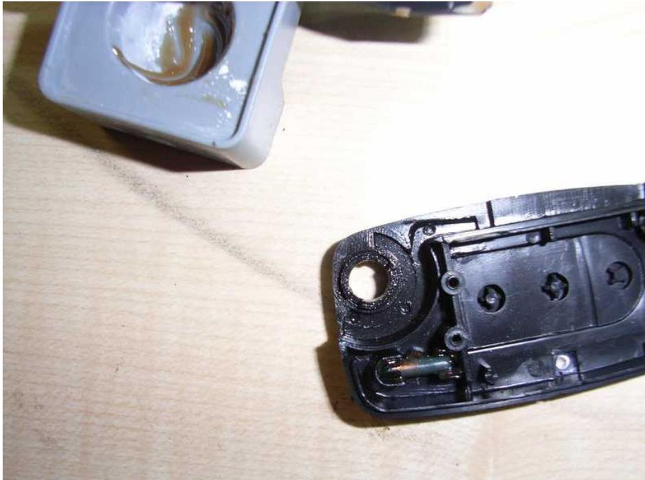
**9. Nun muss nur noch der Schlüssel angebracht werden. Dazu müsst Ihr den Schlüssel halb aufklappen und die beiden Schrauben (Vorder- und Rückseite) lösen. Dann lässt sich der Dummy einfach herausziehen.**
