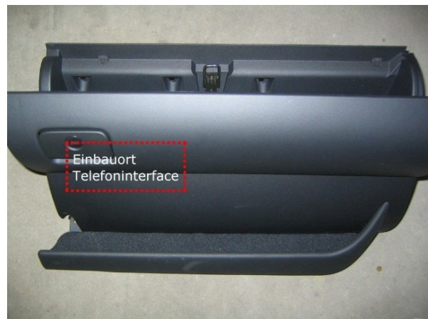
Bild 19: Einbauort Telefon Interface
