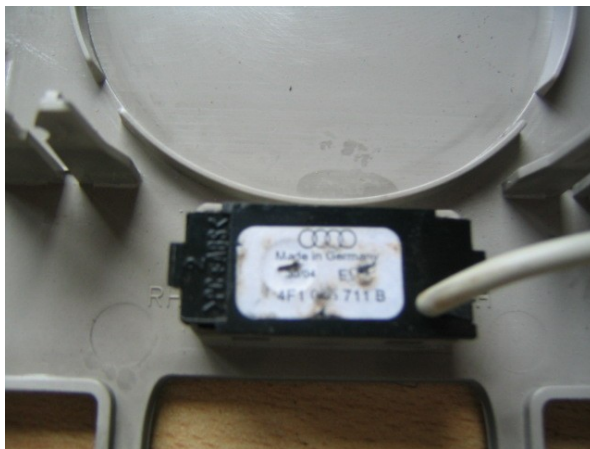
Bild 9: Innenraumleuchte vom A4 eingebaut
