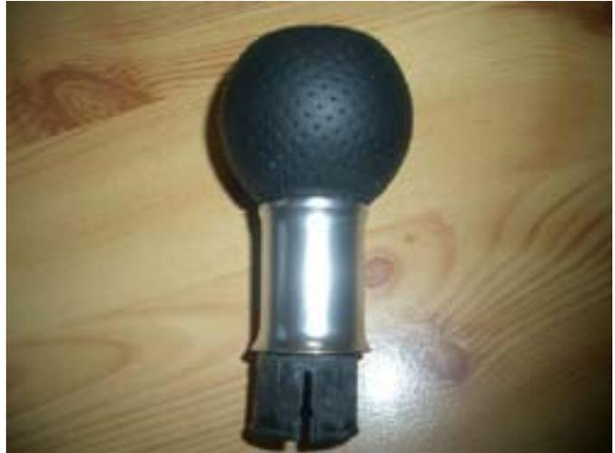
Vollbracht! Jetzt muss der neue Schaltsack noch dran, der wird erstmal einfach drauf gezogen so weit wie möglich ran an die Hülse.
