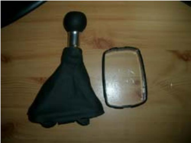
Jetzt muss nur noch der Schaltrahmen vom alten in den neuen Sack eingetackert werden. Es ist nicht so ganz einfach, da der Schaltsack vom Facelift / S-Line etwas kleiner ist, von daher muss man etwas ziehen, aber es passt!
