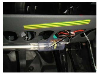
weiter zum Zigarettenanzünderplus. (Kann aber auch ein x-beliebiger Pluspol sein.) Zur Befestigung der Röhren muss jeder selbst entscheiden, wie er sie befestigt. Ich habe sie mit kleinen Schrauben in die Plastikabdeckung im Fußraum befestigt. Man kann sie natürlich auch anders befestigen (z.B. Kabelbinder).
