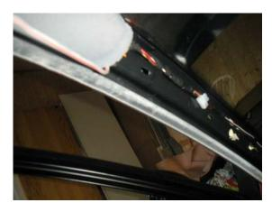
Das Kabel an der A-Säule am Besten mit etwas Klebeband an den vorhandenen Kabeln befestigen.
