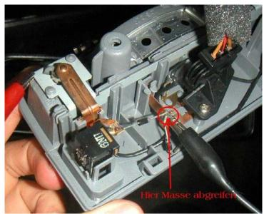
Die markierte Stelle an der Innenraumbeleuchtung zeigt die geschaltete Masse, die durch den Türkontakt geschaltet wird.
