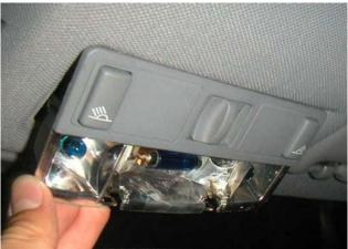
Danach wie im Bild die komplette Beleuchtungseinheit vorsichtig zu sich herunterklappen. Bei anderen Modellen wird auch diese Aktion ähnlich der hier beschriebenen sein. Nun muss man ein Kabel von der Innenraumbeleuchtung nach unten zu den Neons legen. Dafür montiert man die A-Säulenverkleidung und den Deckel vor den Sicherungen ab.
