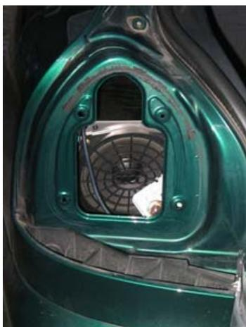
Wenn ihr das alles erledigt habt, bietet sich folgendes Bild und ihr könnt mit dem Einbau eurer neuen Rückleuchten beginnen, der Einbau erfolgt natürlich in umgekehrter Reihenfolge (Rückleuchten einsetzen, an den 4 Punkten festschrauben, Lampenträger einsetzen, Stecker aufstecken, Verkleidung im Kofferraum wieder schließen).
