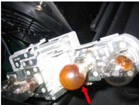
Da bei den Vorfacelift-Rückleuchten eine weiße Birne für den Blinker genutzt wird (die orange Farbe beim Blinken entsteht durch orange-farbigem Plastik in den Vorfacelift-Leuchten), müsst Ihr diese Birne bei den Facelift-Rückleuchten gegen eine entsprechende in orange oder noch besser gegen z.B. Philips Silver Vision austauschen. Da die Silver Vision nicht orange, sondern silbern sind, aber dennoch orange blinken, siehts optisch einfach besser hinter dem weißen Glas der neuen Leuchten aus.
