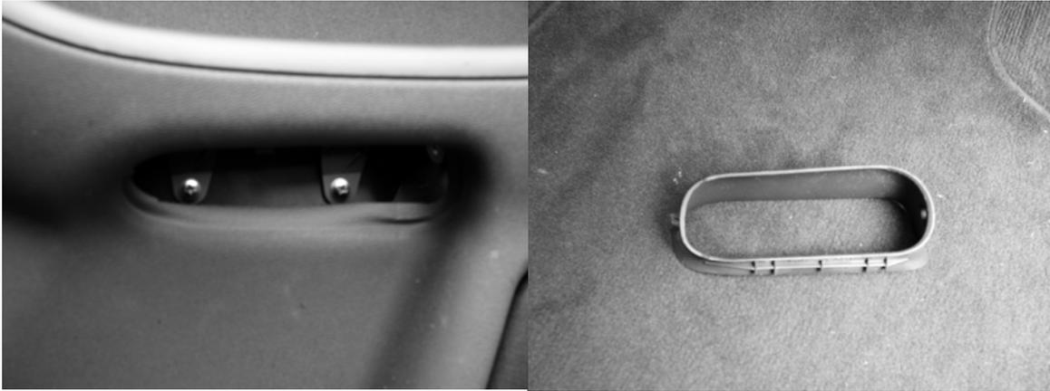
Nun, wenn diese Arbeiten abgeschlossen sind, geht es an die Türverkleidung heran. Diese ist nur eingehangen. Durch leichtes nach oben drücken, rutsch die Verkleidung aus ihrer Verankerung und man gelangt hinter die Verkleidung.
