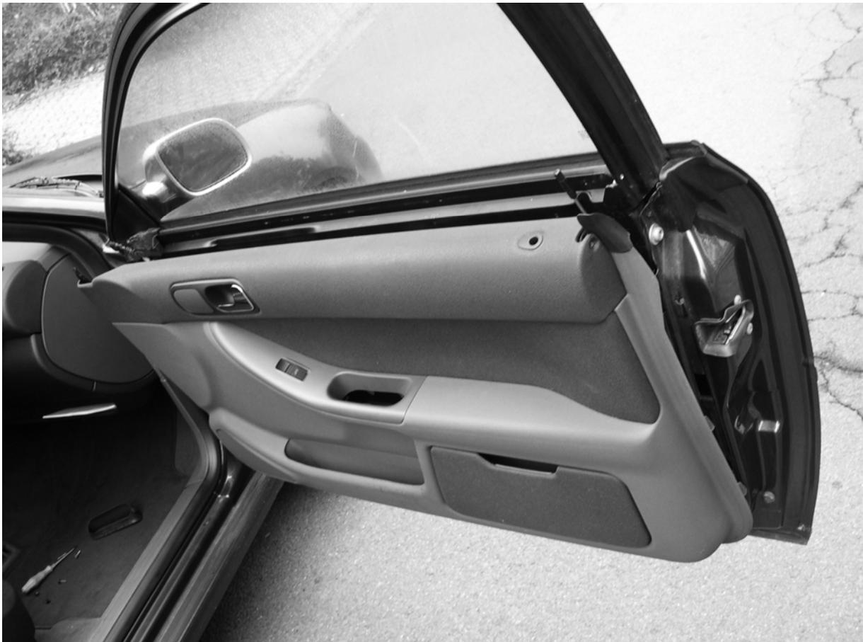
Die Türverkleidung braucht nicht komplett gelöst werden, sondern nur soweit, bis man an die 4 Schrauben gelangt, die mit der Griffschale verschraubt sind und unter zur Hilfenahme der Ratsche mit der 15 Torx zulösen sind.
