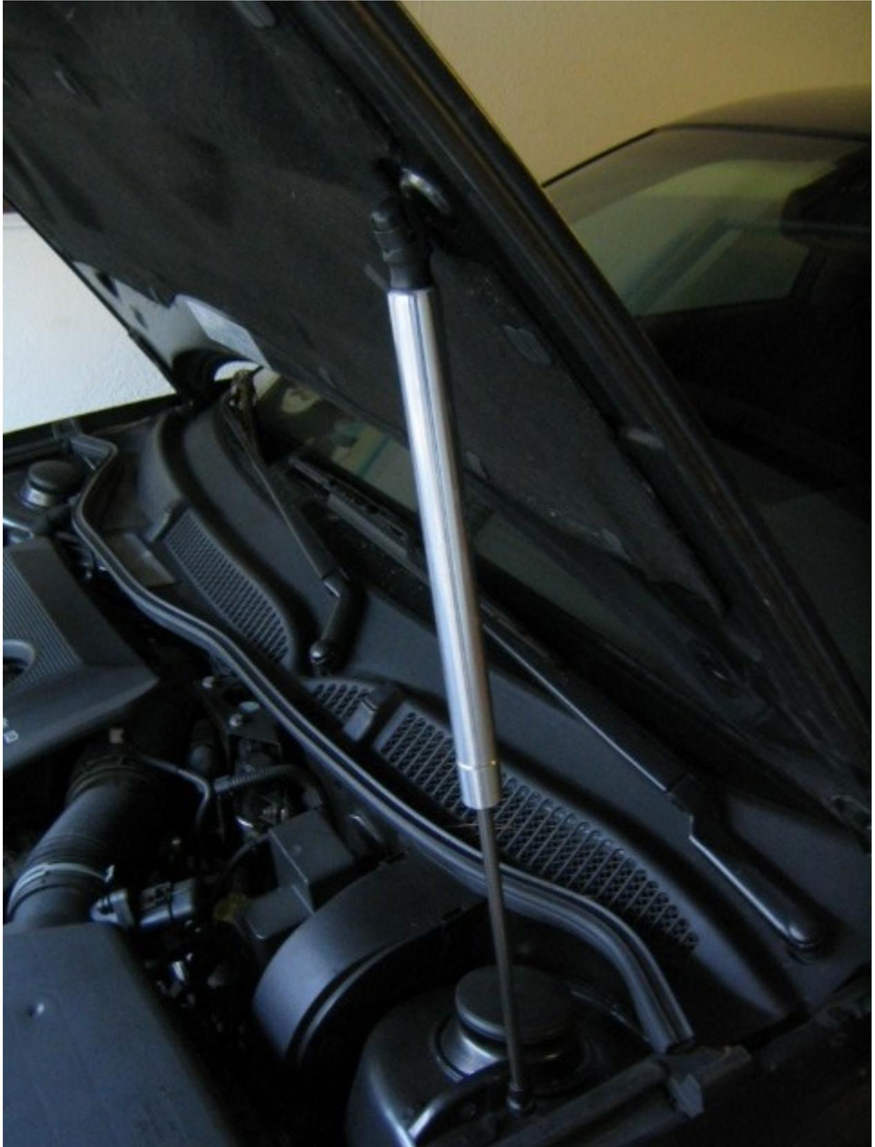
**Gasdruckfeder vom Passat Kombi – passt auch an der Motorhaube!**
