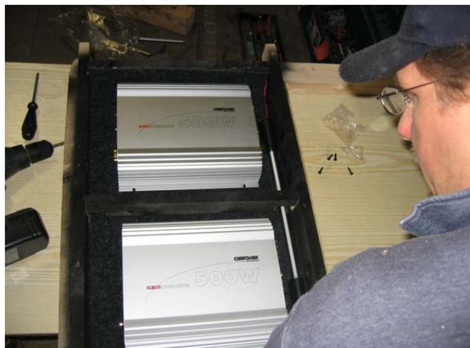
Um die Endstufen in Szene zu setzen werden sie unter einer Plexiglasabdeckung verbaut. Hierbei haben wir die Wahl zwischen zwei Varianten. Einmal besteht die Möglichkeit, die Scheiben größer auszulegen und an den Ecken zu verschrauben. Damit die Plexiglasplatten aber bündig mit der Platte abschließen, wurde die Bodenplatte an den Öffnungen für die Plexiglasscheiben mit Hilfe der Oberfräse mit einer Nut versehen.
