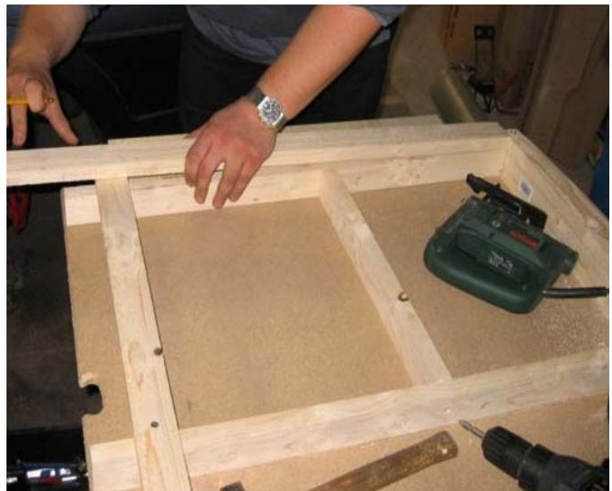
Dann kommt wieder unser die Stichsäge zum Einsatz. Jetzt werden die Ausschnitte für die Endstufen und den Bass in die Oberplatte geschnitten. Bei solchen Arbeiten immer nötige Schutzkleidung tragen, leider ist dies auf dem Bild nicht der Fall. Da es sehr stauben kann, ist eine Brille zum Schutz der Augen sehr wichtig.
