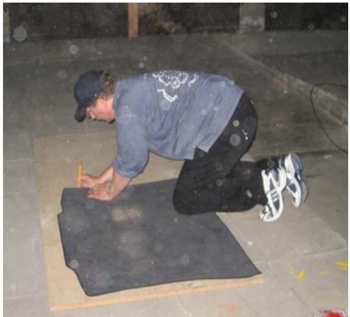
Jetzt wird die Bodenplatte zur Probe in den Kofferraum gelegt. Man sollte hier die Mulde für das Warndreieck beachten, die Platte sollte nicht zu hoch aufgelegt werden. Wenn alles passt, kann man sie wieder entfernen, falls etwas nachgebessert werden muss, ist dies der richtige Zeitpunkt.
