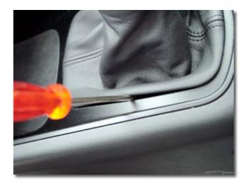
Das neben stehende Bild zeigt den Kunststoffrahmen, an dem die 5 Klippser/Halter angebracht sind. Diese müssen von der Konsole gelöst werden, indem man den Rahmen mit dem Schraubenzieher an beiden Seiten ein wenig von der Konsole wegdrückt.
