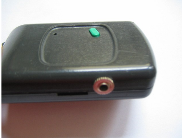
Foto 3: Funksender mit eingebauter Klinkenbuchse
