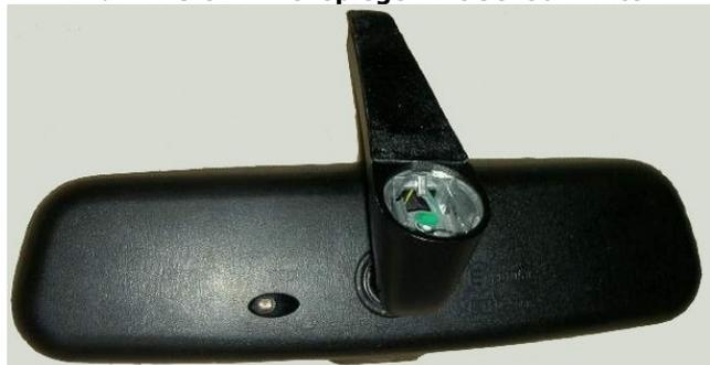
Bild 2: A3 8L Innenspiegel mit Sensor vorne
