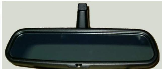
Bild 1: A3 8L Innenspiegel mit Sensor hinten
