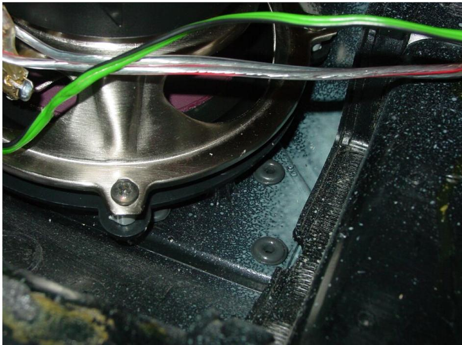
Nachdem die LS (Schrauben 3,5x20mm) sowie Hochtöner verbaut und verkabelt sind, kann man die Frequenzweiche unter einer Schaumstoffaussparung befestigen. Ich habe diese mit einer Schaumstoffmatte gegen Vibrationen gesichert, zudem verschraubt (3x15mm) und noch mal mit Gewebeband an die Türe geklebt.
