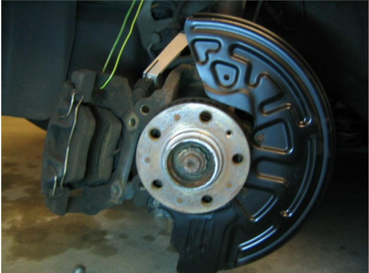
Bild 4: Neues Deckblech. Es ist um einiger größer als das alte!
