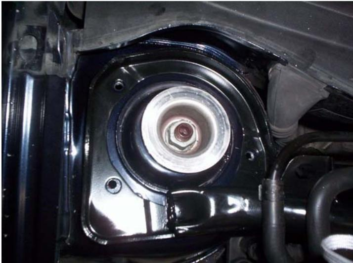
Nun von unten die Schrauben eindrehen und mit Hilfe eines Sicherungslackes oder Loctite die Schrauben zusätzlich sichern.
