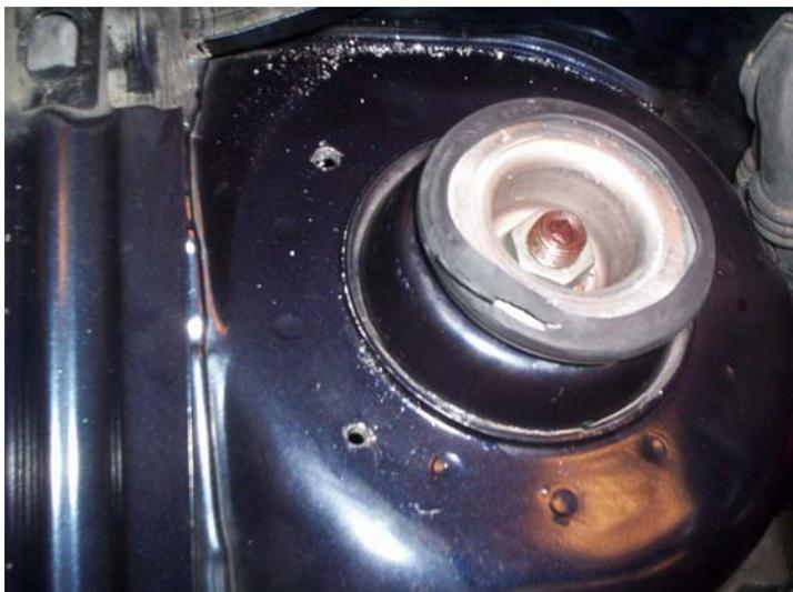
Alle Löcher sind gebohrt und am oberen ist das Gewinde schon geschnitten.
