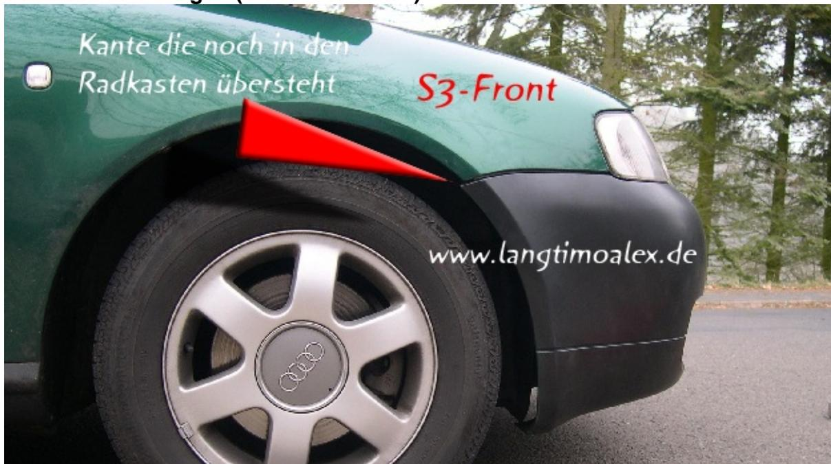
Natürlich steht diese Kante nicht im Widerspruch mit einer Befestigung der Front, nur schaut es halt nicht optimal aus, und wirkt dadurch wie rangebastelt. Da ich ein perfektes Ergebnis erzielen wollte, musste die Kante an die Form des Radhauskastens angepasst werden.
