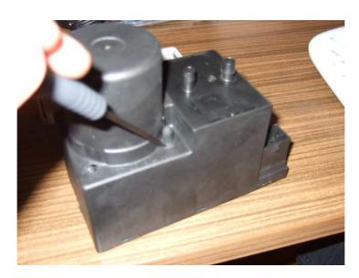
Den Motor kann man einfach mit einem Schraubenzieher lösen, indem man die 4 Gumminippel mit dem Schraubenzieher rings rum herunterdrückt bis sie verschwunden sind. Vorsicht nicht kaputtmachen !!!
