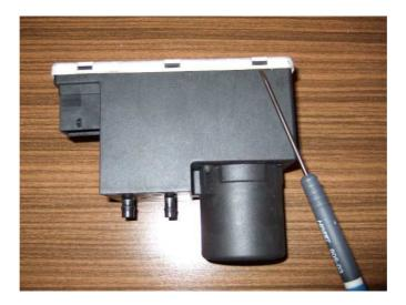
Schritt 2: Pumpe öffnen
