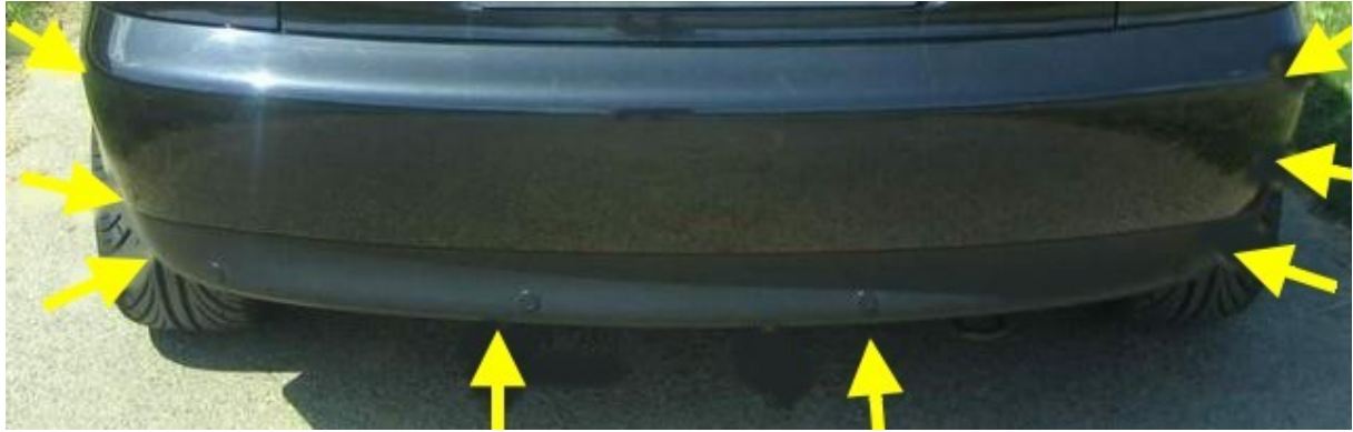
Bild 9: Lage der Torxschrauben
