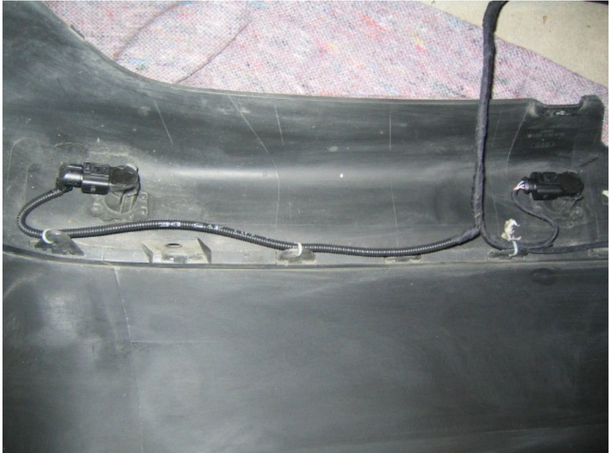
Bild 14: Kabelbaum für die Sensoren fertig verlegt
