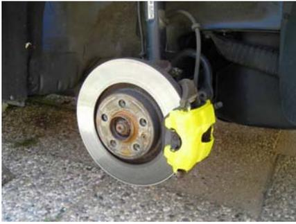
7. Bevor die zweite Schicht aufgetragen wird, muss der Lack fingertrocken sein
