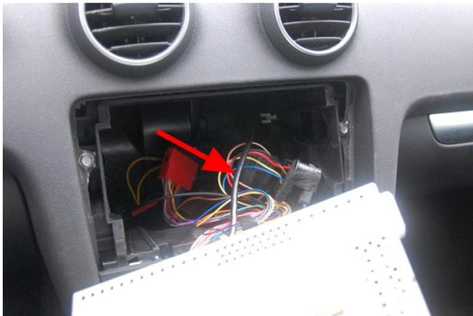
Hier können Sie sehen, wie das Anschlusskabel des USB-Adapters vom Radio in Richtung Handschuhfach verlegt wurde.
