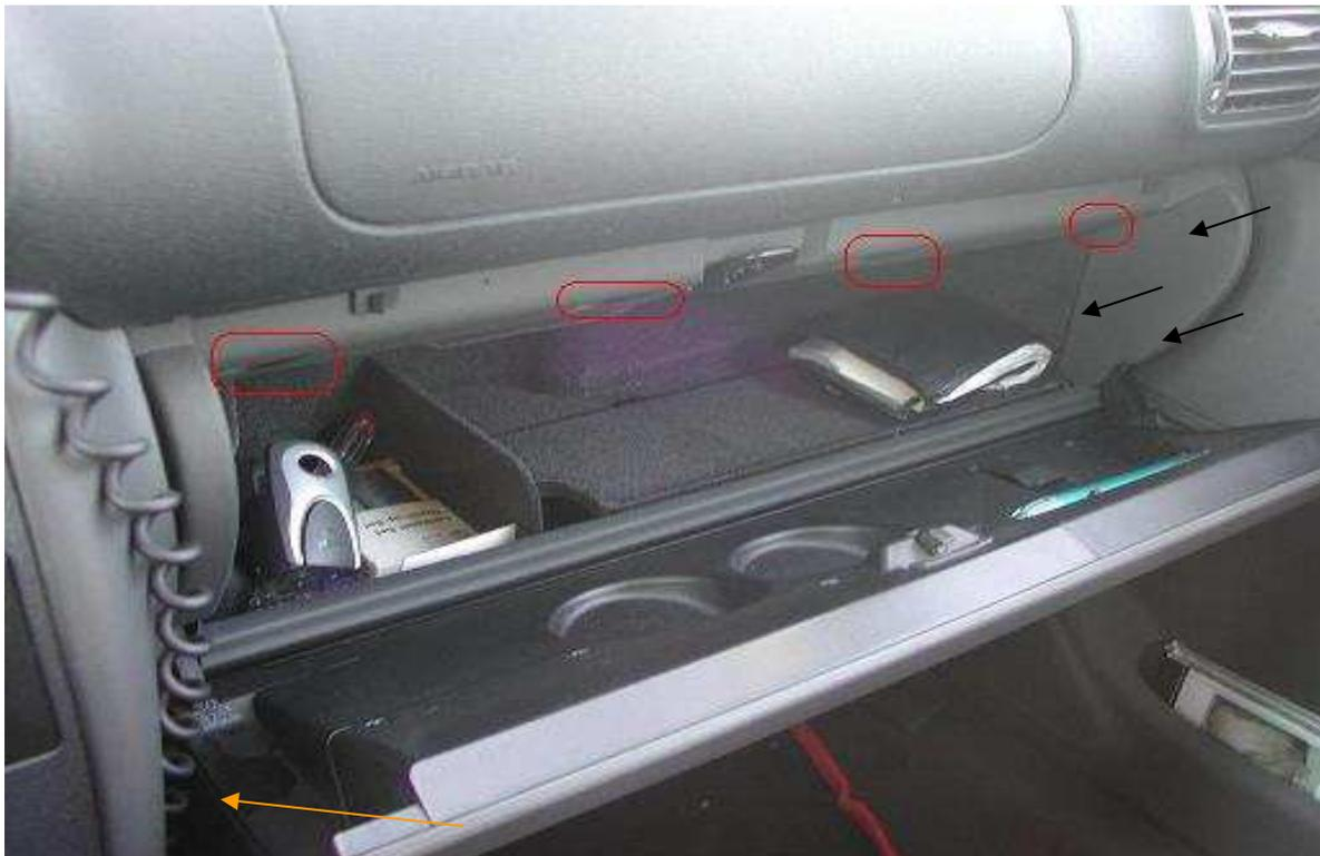
**Habe also die Kabelenden der rechten Düse mit Lautsprecherkabel verlängert und mit den Kabeln der mittleren Düse verbunden – mit einem Schrumpfschlauch das ganze isoliert und einen weiteren Funktionstest vorgenommen.**
