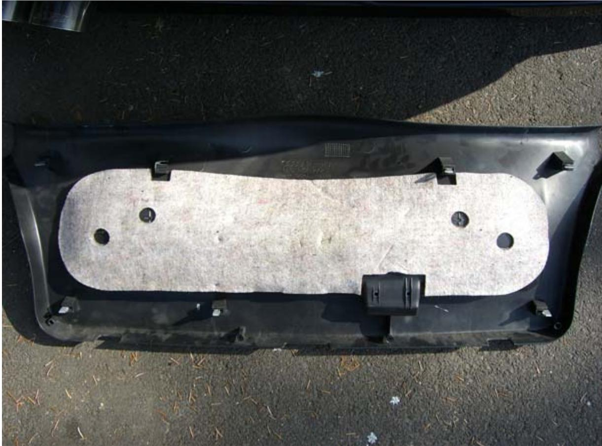
Die Verkleidung sieht abmontiert so aus und ist im Endeffekt mit 7 Metallklammern befestigt.
