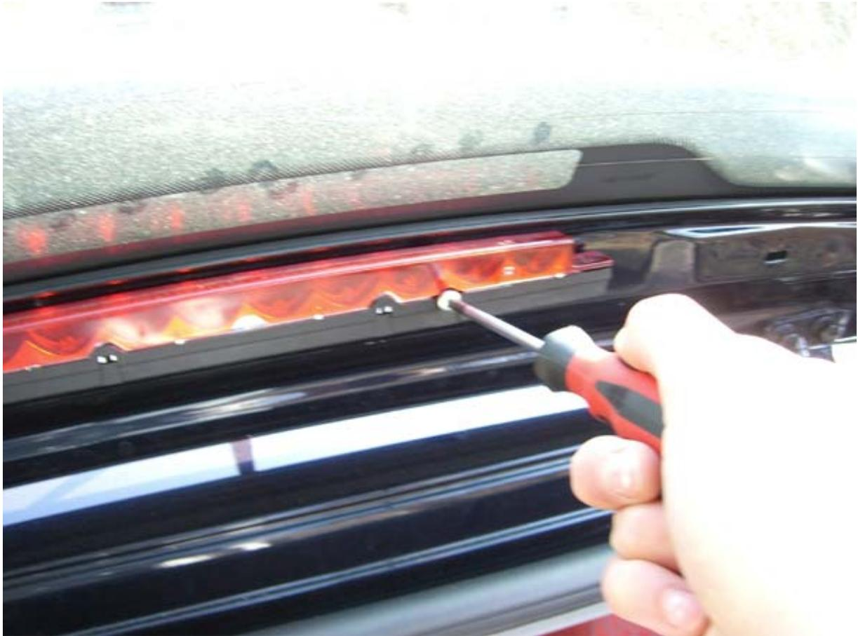
Nun schraubt ihr die Schraube von der Rückleuchte ab und nehmt die Rückleuchte ab. Sie ist mit dem kleinen Haken hier zusätzlich auf der linken Seite befestigt.
