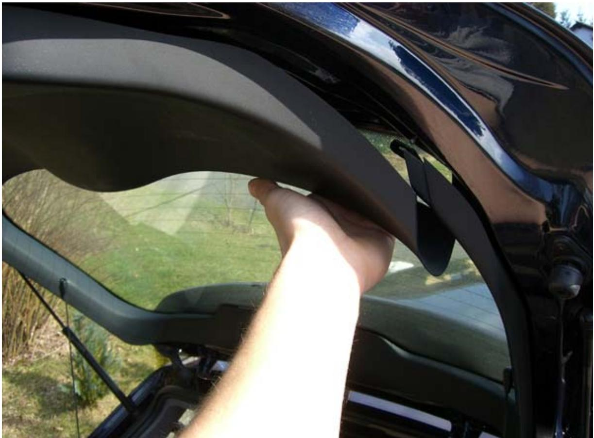
Am besten packt ihr die Heckklappenverkleidung auch an der Stelle wie auf dem Bild zu sehen und zieht sie nach unten und mit der anderen Hand gegen die Heckklappe gegen drücken.
