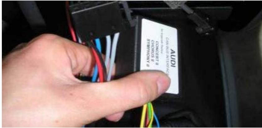
Das Auslesen der can-Impulse des Radios erfolgt über einen grünen mini-iso stecker, der einfach an den vorhandenen gelben angehängt wird.
