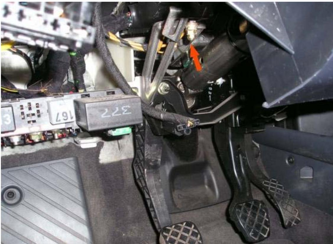
Danach muss der Hebel für den Motorhaubenzug entfernt werden und die Verkleidung darunter abgenommen werden. Anschließend kann man dann die Einstiegsleiste ausclippen und erhält so Zugang zum Kabelkanal:
