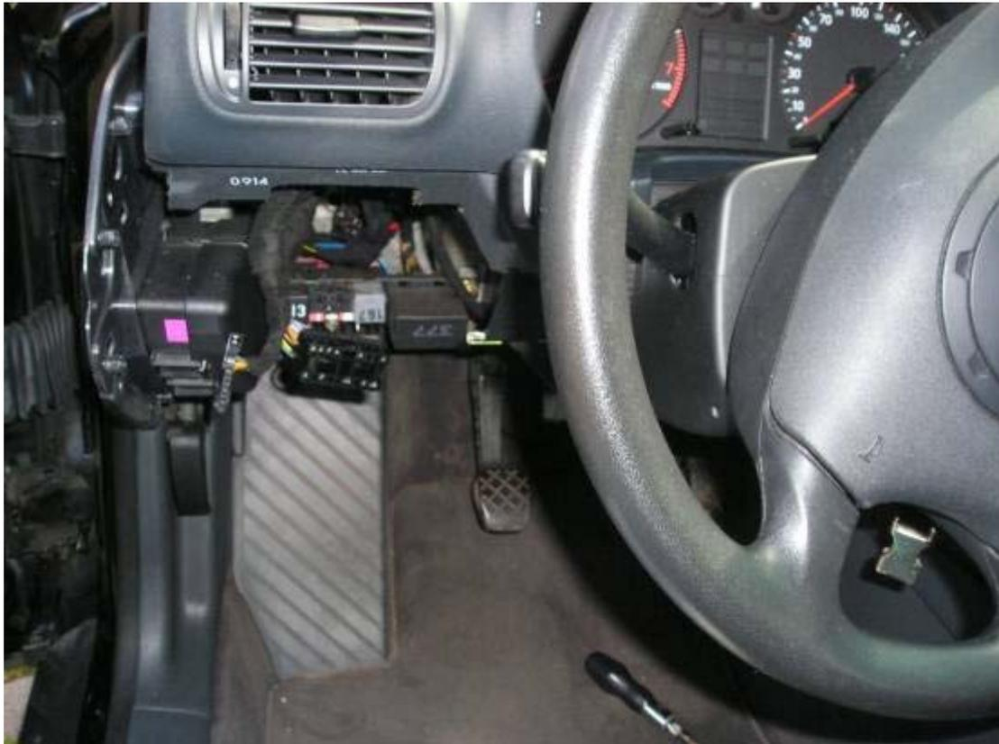
Jetzt kann man das Kabel vom Radio zur linken Seite hin verlegen. Gleichzeitig kann man an dem unterm Lenkrad befindlichen Massepunkt die Masse des Wechslerkabels anschließen:
