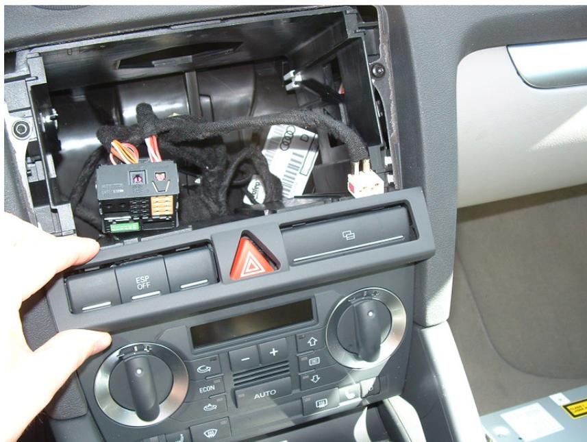
Den Blinddeckel entfernen und das Ablagefach ausbauen, hier wird die Beleuchtung angeschlossen da es die wenigsten Probleme bereitet
