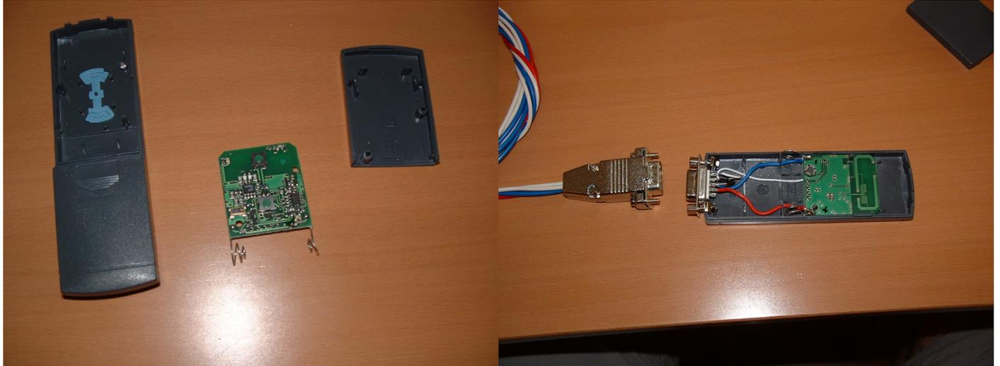
Ich habe eine rs232 Buchse verwendet um die Tastereingänge und eine Spannungsversorgung herzustellen. Entsprechend wird bei mir ein Anschlusskabel benötigt, da mein Sender im Handschuhfach befestigt wird.
