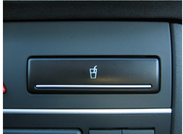
Foto 14: Getränkehalter fertig eingebaut
