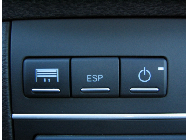
Foto 13: Schalter/Blinddeckel fertig eingebaut
